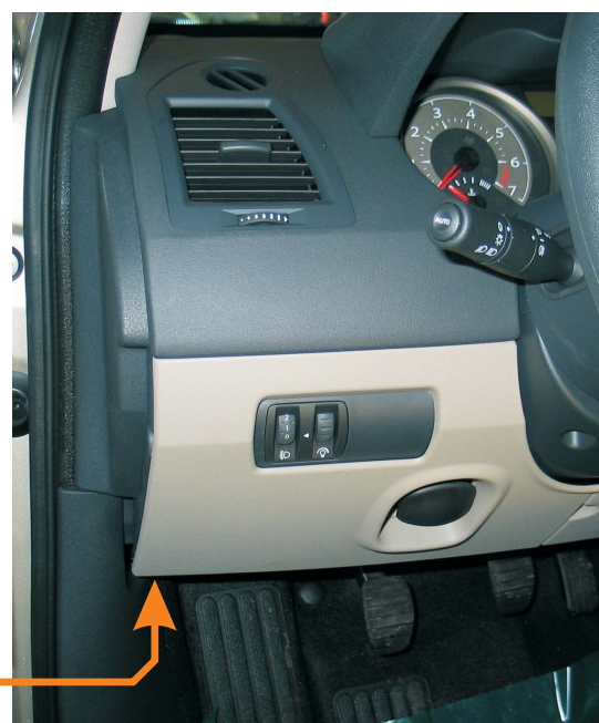
Złącze widoczne od dołu (przyklejone do wiązki)
